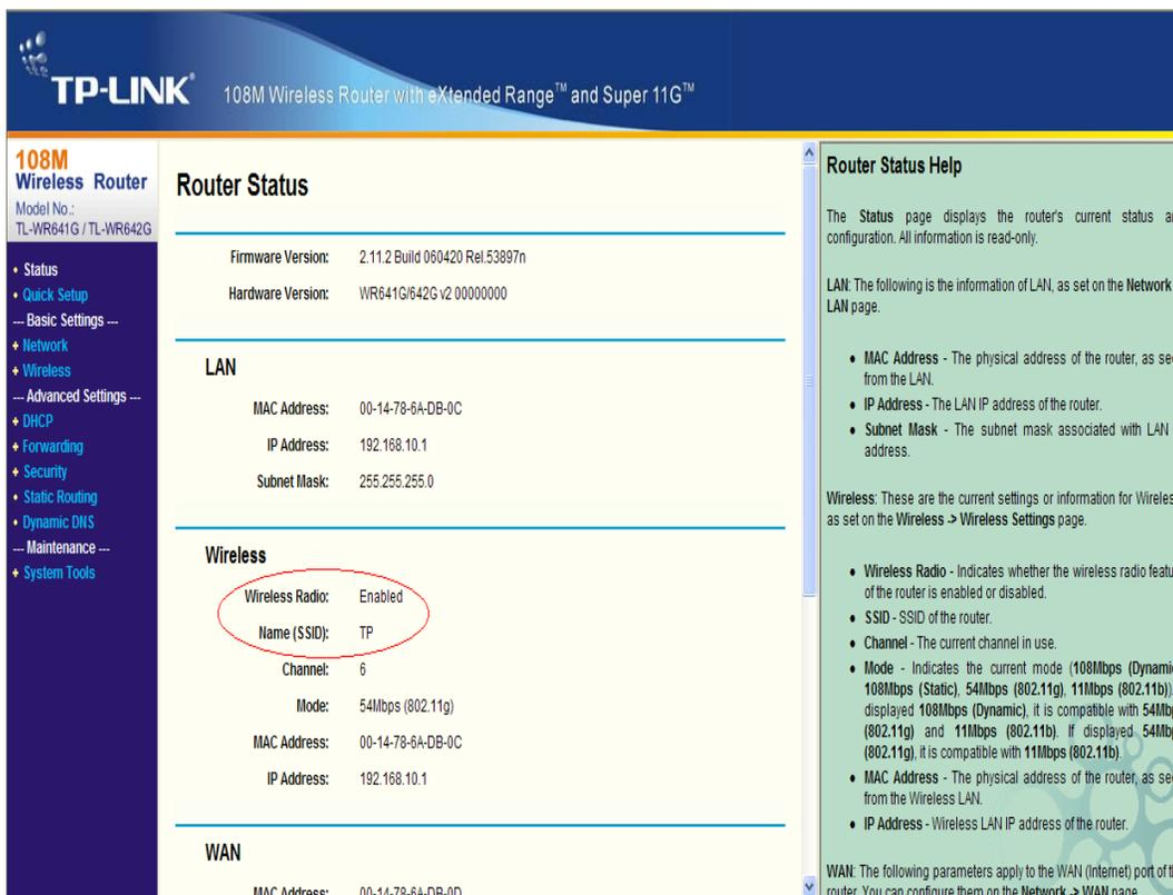
Fig.3.5.1 Router wireless parameter configuration
