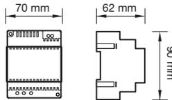
Die Schutzabdeckungen der Klemmen wieder anbringen. Die Öffnungen und Schlitze zur Belüftung und Wärmeableitung nicht verschließen.
